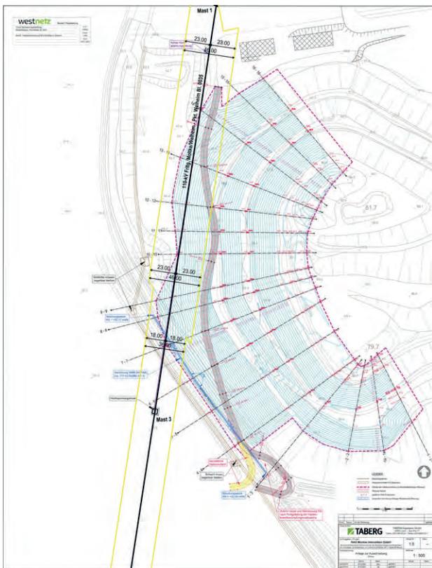
Bild 9.9 – Übererdungsbereich (hellblau) mit Darstellung Sicherheitsbereich Hochspannungsleitung
