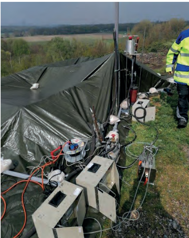
Bild 9.13 – Anordnung der Emissions-Messstelle mit Speichertechnik
