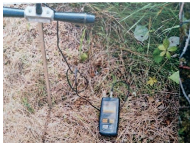
Bild 9.4 – Oberflächen-Temperaturmessung mit Stechsonde
